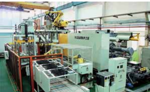
▲ 伊之密打造全自动压铸岛测试平台，模拟“无人工厂”
