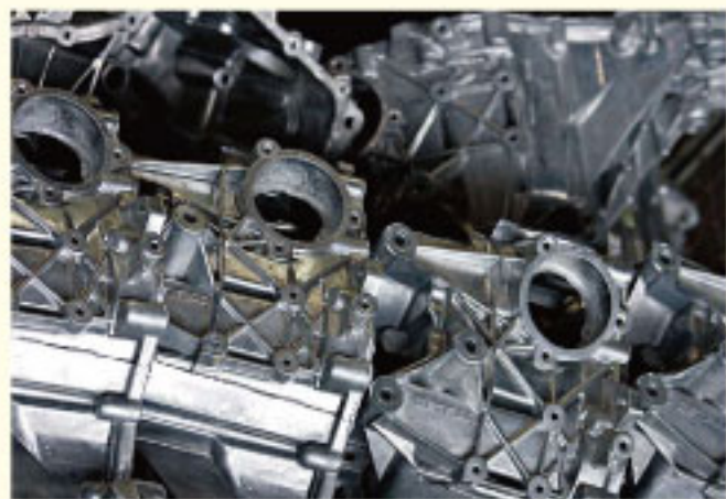
在波兰Nemak公司，发动机缸体采用机器人铸造自动化后生产节拍加快了25%。
